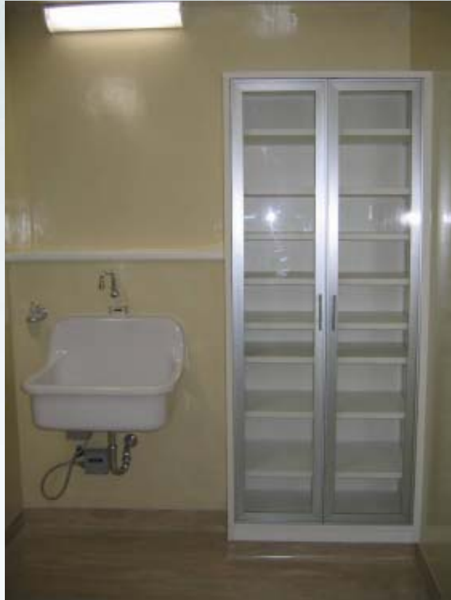
ภาพที่ 10 แสดง Anteroom ที่มีอ่างล้างมือ ตู้เก็บเครื่องป้องกันร่างกาย สะอาด และมีบริเวณเพียงพอที่จะทิ้งเครื่องป้องกันร่างกายที่ใช้แล้ว
