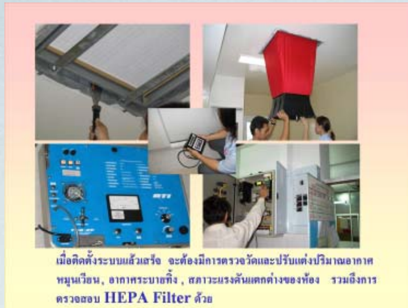
ภาพที่ 14 แสดงการทดสอบระบบกรองอากาศ ความดันอากาศ และปริมาณ อากาศหมุนเวียน ของห้องแยกผู้ป่วยก่อนการใช้งาน
